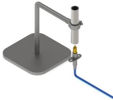
Figura 1.1 - Esquema simplificado da bomba ejetora para sistemas de queima (implementado em CAD )
