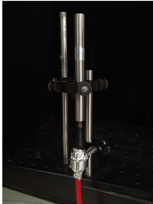
Figura 3.1 – Fotografia da configuração experimental do queimador
